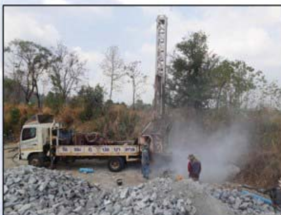
รูปที่ 12 ภาพการเจาะสำรวจแบบเก็บเกล็ดตัวอย่างหินที่หลุม BH-2
