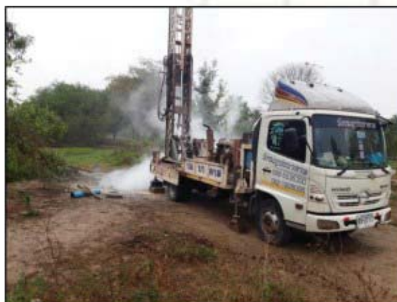
รูปที่ 13 ภาพการเจาะสำรวจแบบเก็บเกล็ดตัวอย่างหินที่หลุม BH-3
