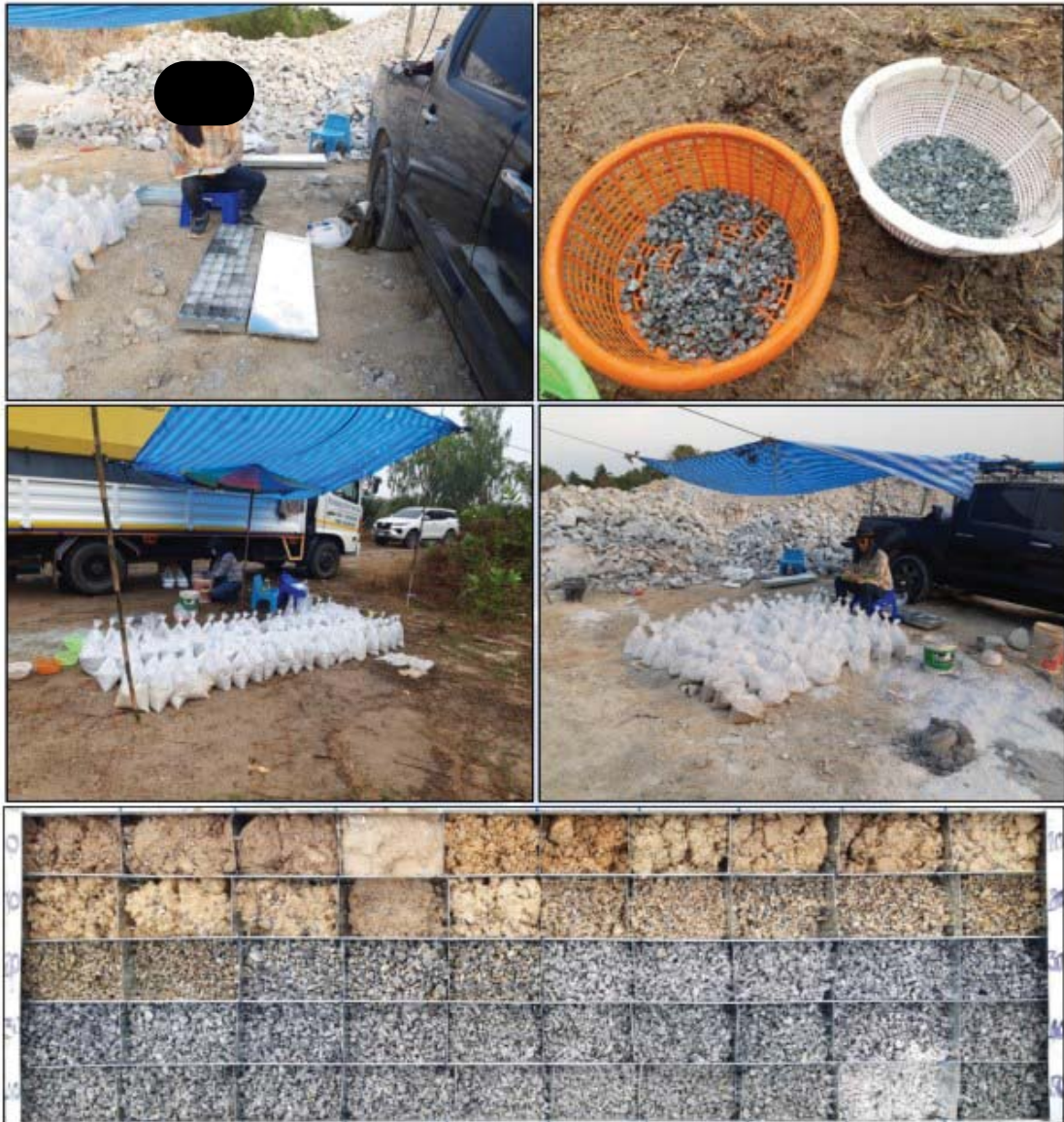
รูปที่ 14 ภาพการเก็บเกล็ดตัวอย่างหินจากหลุมเจาะสำรวจ
