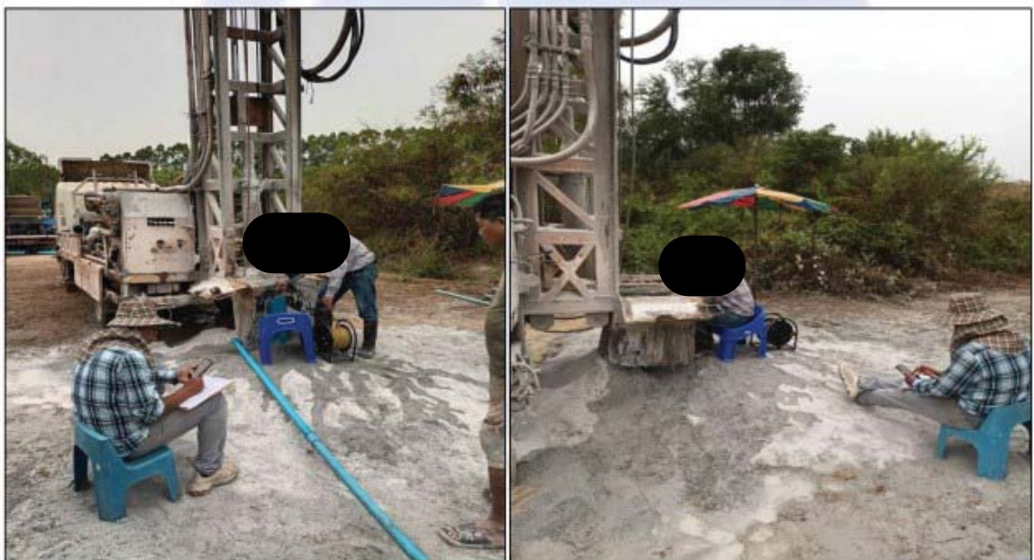
รูปที่ 19 แสดงการวัดระดับน้ำขณะทำการทดสอบ Slug Test
