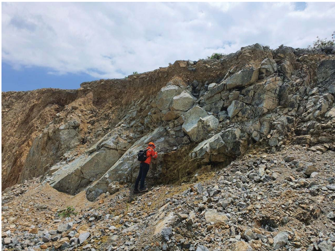
รูปที่ 3 การตรวจวัดความไม่ต่อเนื่องของชั้นหินบริเวณบ่อเหมืองข้างเคียง (มองไปทางด้านทิศตะวันออก)
