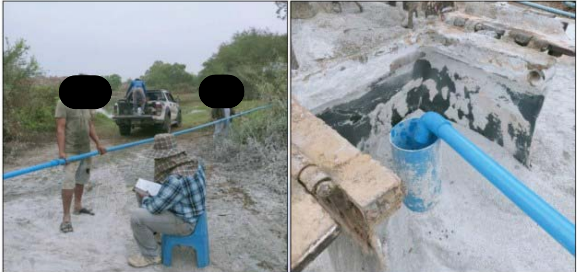
รูปที่ 18 แสดงการสูบลูกกรอกน้ำให้เต็มบ่อเจาะสำรวจ BH-3 เพื่อเริ่มการทดสอบ Slug Test
